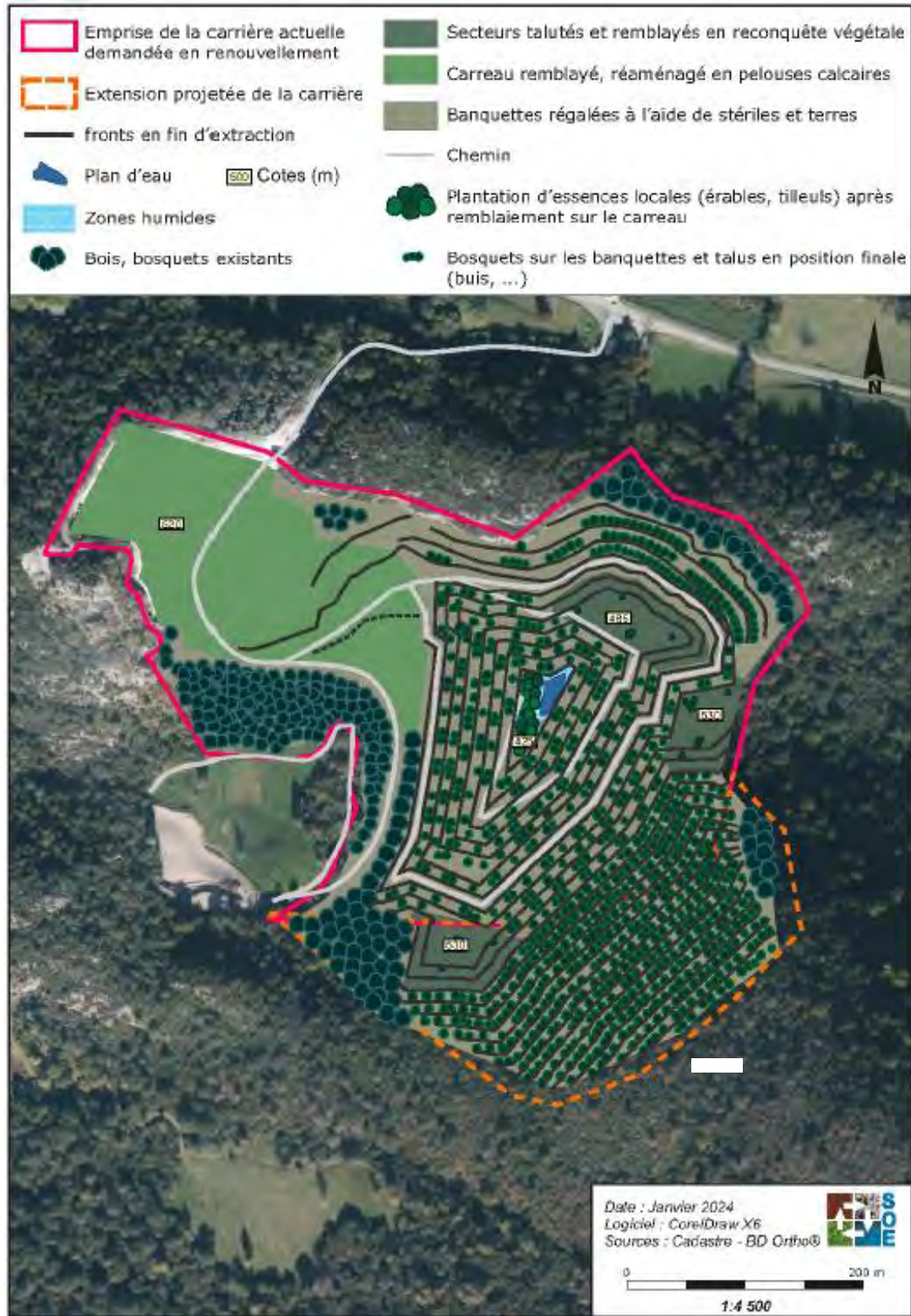
Figure 12. Principe du réaménagement du site
