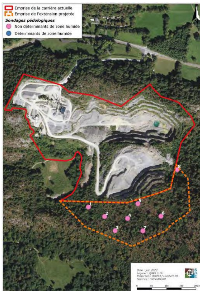
Carte de localisation des sondages pédologiques réalisés sur la zone d'étude. Source : SOE
